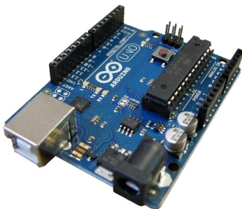
Figura 2 - Modelo de uma placa do Arduino. Fonte: Wikipédia
