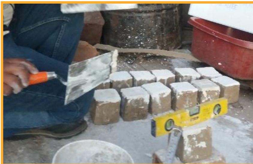
Nota. El tapado llamado como capping a base de yeso.
