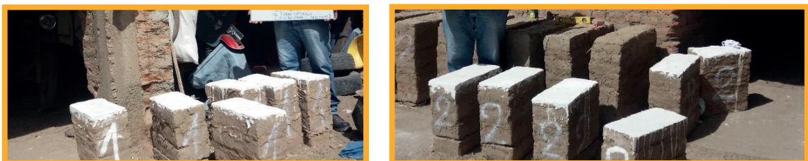
Figura 34. Colocación de una capa delgada con yeso la cara superior de las pilas de 1 % y 2 %
