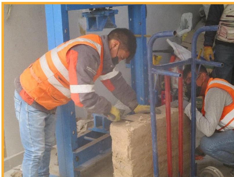
Figura 37. Calado de esquinas de los muretes
