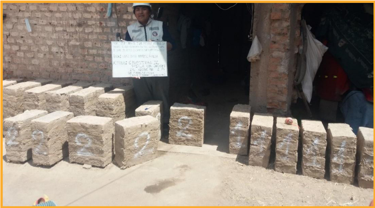
Nota. Secado de pilas del 1 % y 2 % de dosificación
