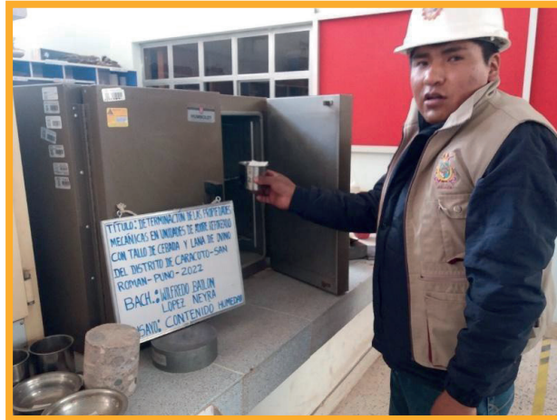
Figura 1. Colocación de la muestra al horno eléctrico para contenido de humedad
