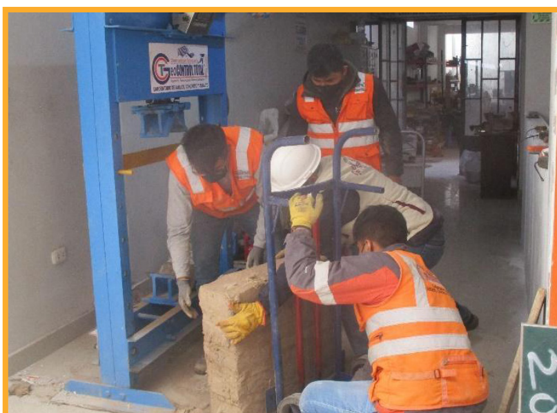
Figura 38. Proceso de colocación del murete a la máquina de ensayo
