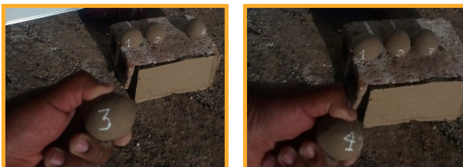
Figura 48. La 3. a y 4. a bolita de la prueba de presencia de arcilla
